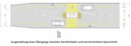
Ausgestaltung eines Übergangs zwischen Kernfahrbahn und normal breitem Querschnitt
