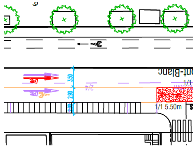
Quai du Mont-Blanc. Violett: Markierung entfernt; gelb: neuer Radweg.
