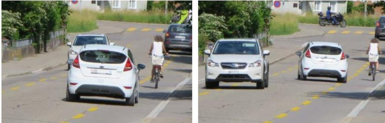
Abbildung 12: Begegnungsfall PW/PW/Velo im Zustand Z1.1: das gleichzeitige Überholen eines Velos und Kreuzen eines anderen PWs ist nur bei geringer Geschwindigkeit möglich (wird aber praktisch nie gemacht)
