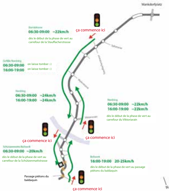
Fig. 2 Concept opérationnel de la coordination des feux de circulation
