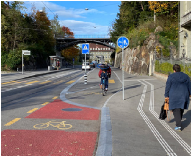
Fig. 12: Contournement cyclable de l'arrêt Kursaal à Berne et arrêt dynamique à la Hünigerstrasse à Bâle (photos: M. Liebi)
