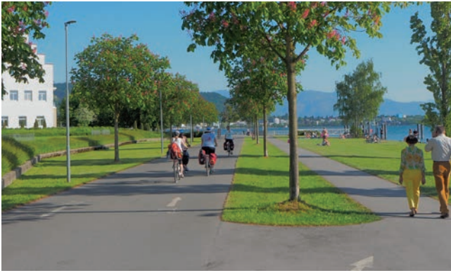
Lochau (Autriche): belle largeur de la piste cyclable et cheminement piéton séparé, dans un environnement arborisé (Photo: David Reinhard)
