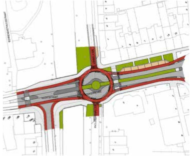
Der Kreisel ermöglicht eine Querung der Hauptstrasse mit Vortritt für Velo; die Abbiegemöglichkeiten für Autos sind eingeschränkt
