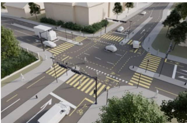
Fig. 8 : Variantes d'aménagement pour le tourner-à-gauche indirect sur toutes les branches, concept pour la Suisse.
