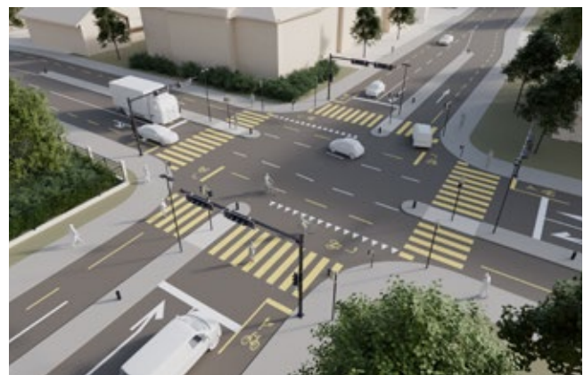
Fig. 8 : Variantes d'aménagement pour le tourner-à-gauche indirect sur toutes les branches, concept pour la Suisse.
