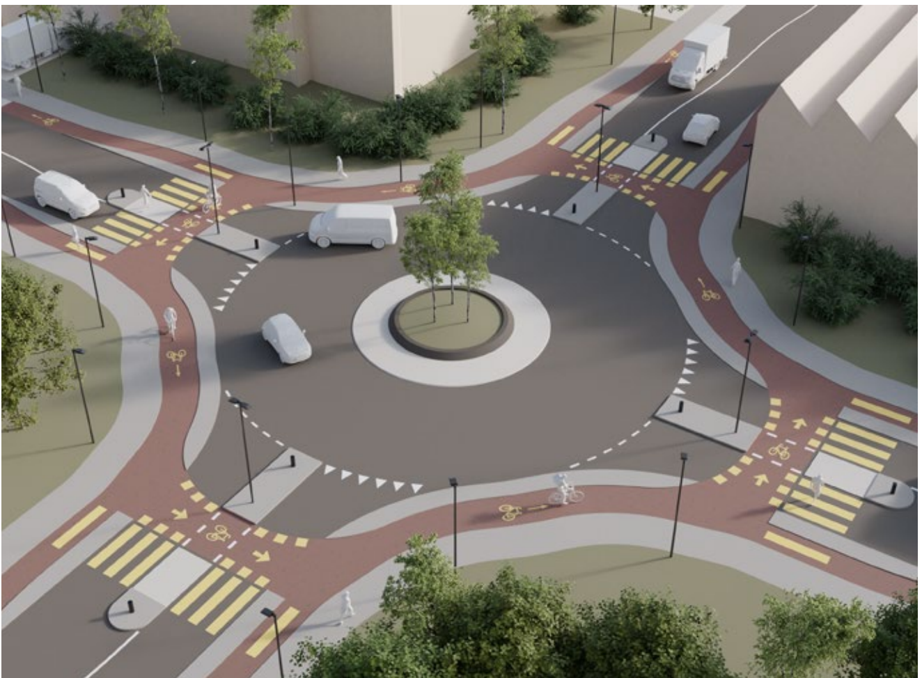
Fig. 5: giratoire avec piste cyclable périphérique et revêtement rouge optionnel pour les surfaces cyclables, concept pour la Suisse.
