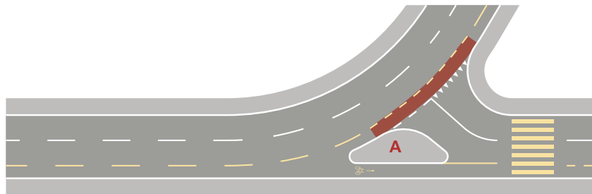
Abb. 424 Ablenkung und Verdeutlichung der Fahrtrichtungen mit Veloweiche
