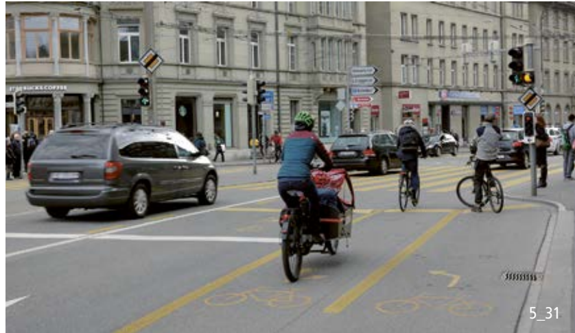
Indirektes Linksabbiegen mit eigenem Radstreifen.
