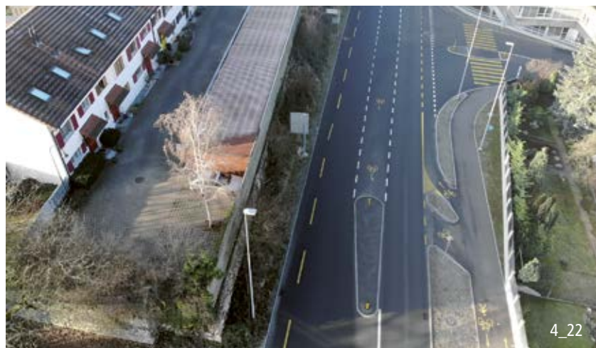
Rückführung des Radwegs auf die Fahrbahn.
