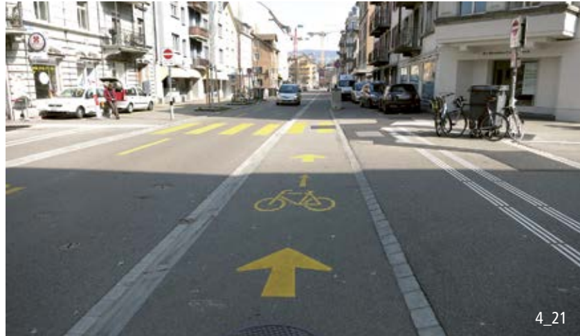
Vortrittsberechtigter Radweg in Kombination mit einer Trottoirüberfahrt.
